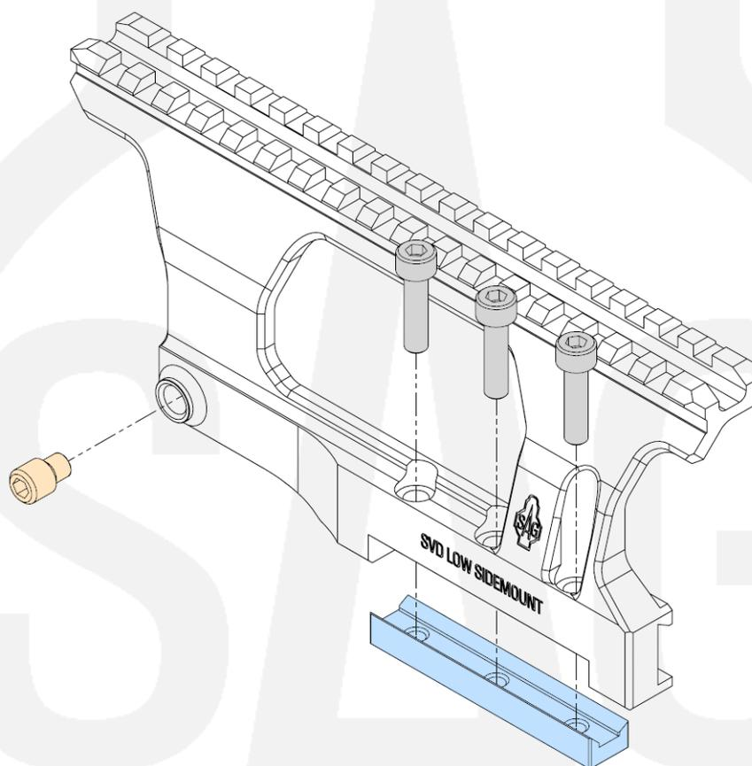
■ прижим    □ винт M5    ■ стопорный винт M8\*
