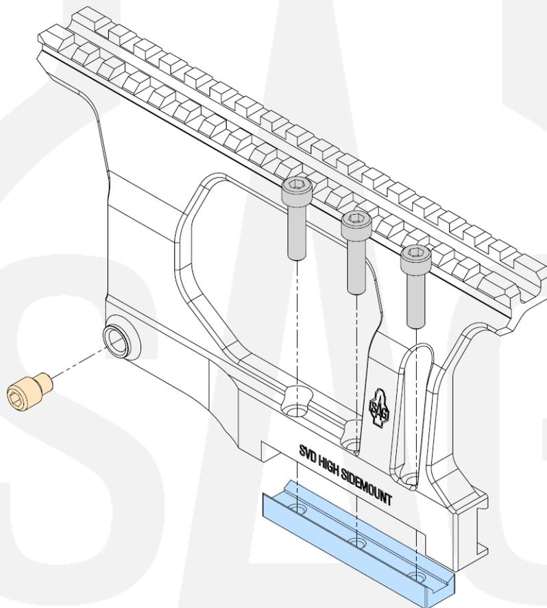
■ прижим    □ винт M5    ■ стопорный винт M8\*
