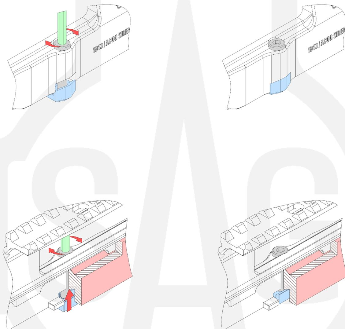
■ прижим   ■ винт M5   ■ шестигранник 4 мм   ■ крепление на карбине
