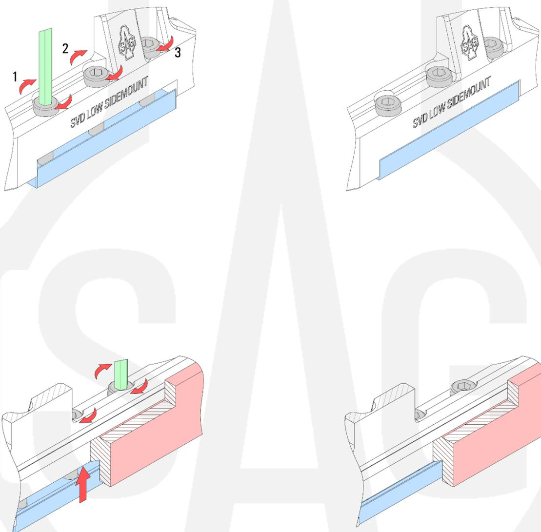
■ прижим    □ винт M5    ■ шестиграннык 4 мм    ■ крепление на карабине
