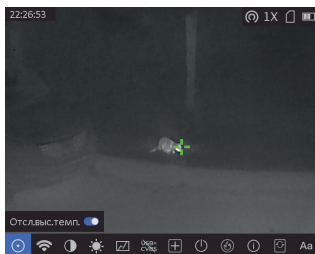
Рис. 4-1. Эффект отслеживания максимальной температуры
