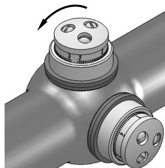
Требуется вертикальная поправка, поверните рукоятку против часовой стрелки.
