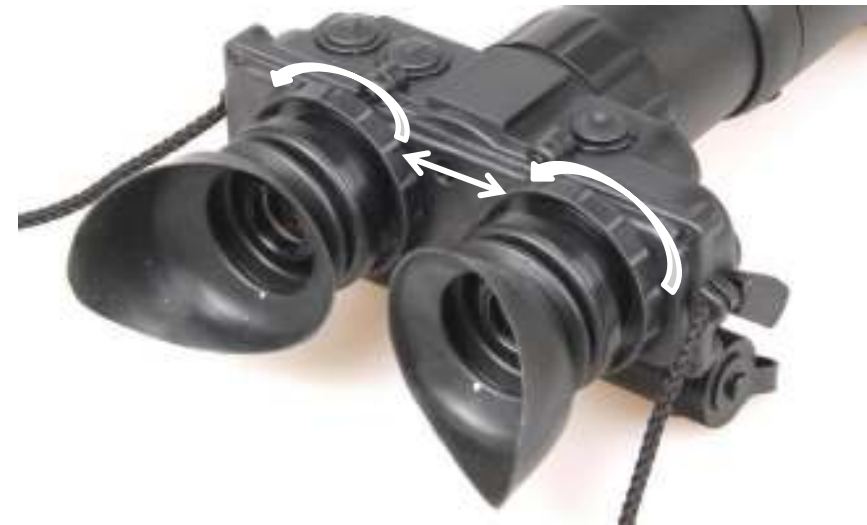
Рисунок 2 – Настройка базы глаз и диоптрийная настройка
