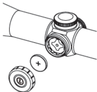
Расположение батарейки в прицелах Leupold серии VX•R
